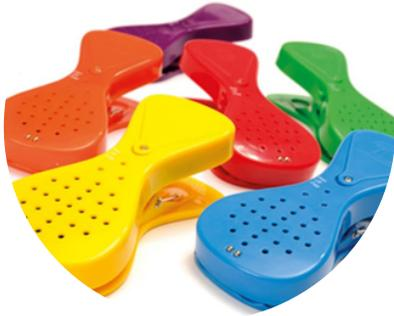
Para grabar los mensajes, sólo necesitamos poner el interruptor en modo grabación "Record" y tocar los dos sensores metálicos. Podremos grabar un mensaje de hasta 10 segundos. Para reproducir el mensaje sólo hay que poner el interruptor en modo reproducción "Play" y tocar los dos sensores. No es necesario presionar, solo con rozarlos funciona, muy adecuado para niño con dificultades de movilidad.
